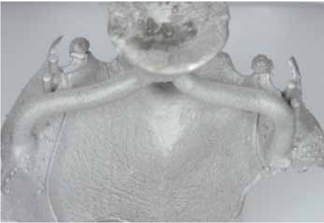
Abb. 11 Nach dem Ausbetten wird der Guss grob abgestrahlt
