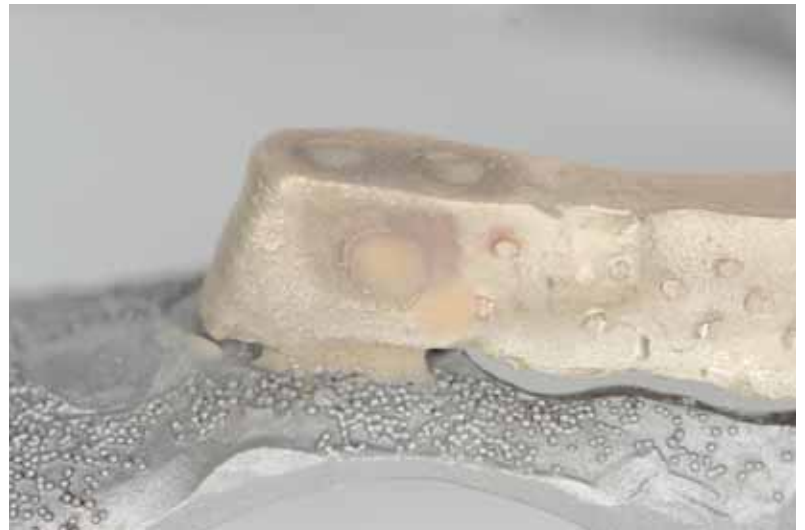
Abb 19 Die aufgefüllte Klebestelle
